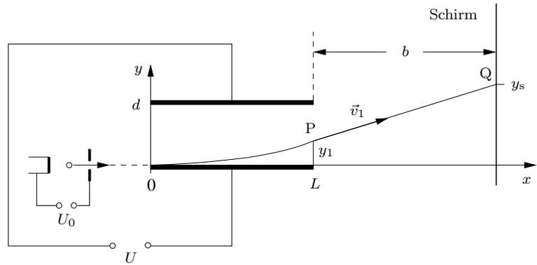
Geschwindigkeit  $v_0$  in das Kondensatorfeld ein. Am Ort P ( $L|y_1$ ) verlassen die Elektronen das Kondensatorfeld mit der Geschwindigkeit  $\vec{v}_1$  und treffen bei Q ( $L + b|y_s$ ) auf einen Leuchtschirm.
