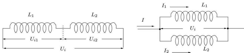
Zeige, dass für Reihen- und Parallelschaltungen von zwei Induktivitäten die gleichen Gesetze gelten wie für Widerstandsschaltungen. Verwende dazu die Beziehung  $U_i = -L \dot{I}$ .
